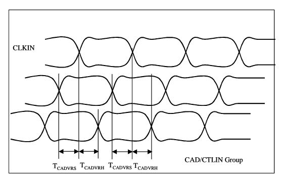
Figure 47.  $T_{CADVRS}/T_{CADVRH}$
